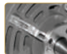
Instalação do epóxi condutivo AEGIS® EP2400
